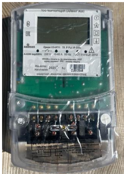
Счетчик «Орман СО-Э711 R TX IP P П RS Z Д (5-60А 220В)» однофазный многотарифный
