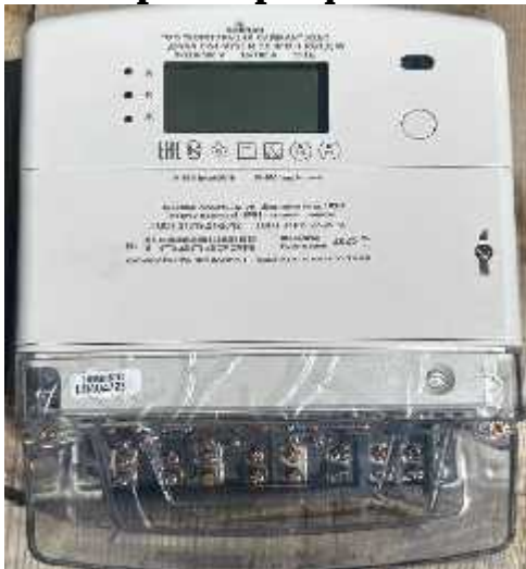
Счетчик Дала СА4-Э720 R TX IP P П RS Д G/PLC (10- 100А 3x220/380В) электронный счетчик активной и реактивной энергии трехфазный
