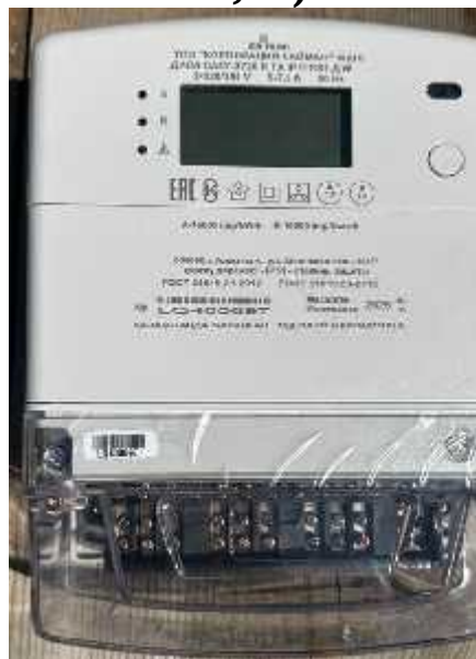
Счетчик эл.энергии трехфазный ДАЛА СА4У-Э720 R TX IP П RS Д G/PLC (3x220/380V 5-7,5A)
